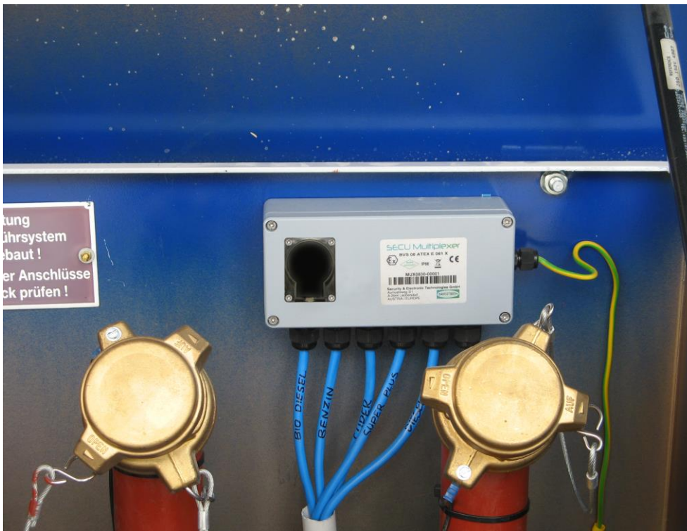
Praxisbeispiel Einbau eines SECU Multiplexers in den Füllschacht
