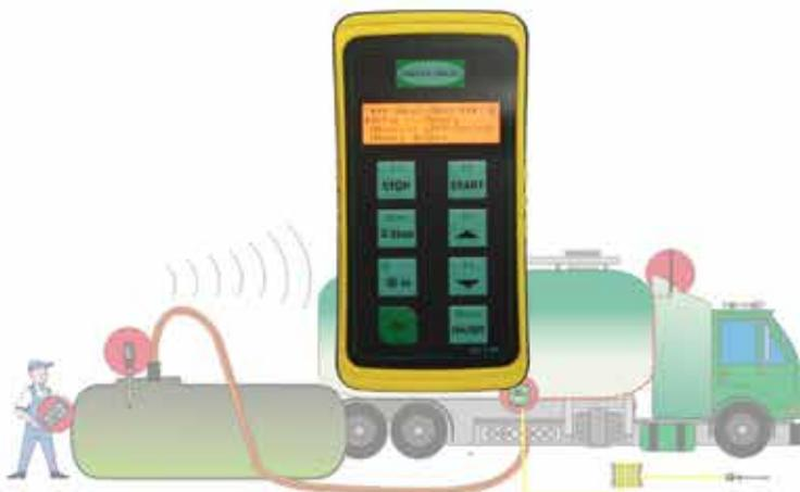
Das LRC3 Programmiergerät dient zur Parametrisierung des LRC3 Systems.
