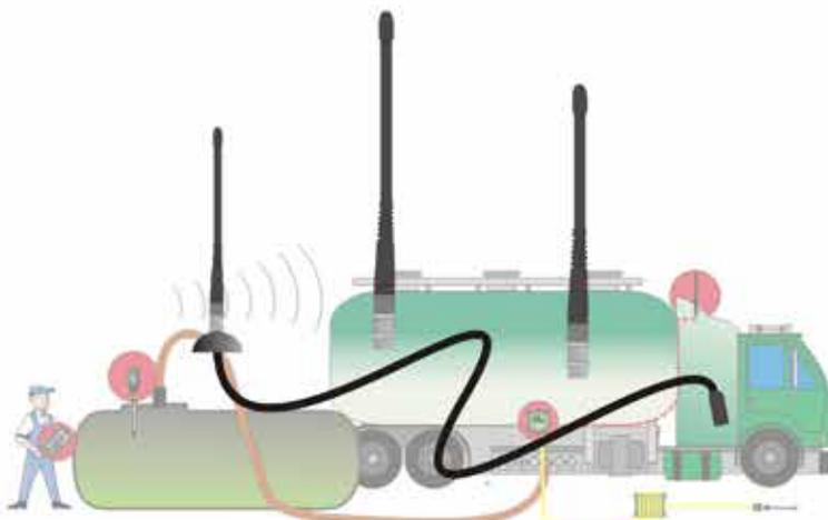
LRC3 benötigt keine eigene Empfangseinheit in Form einer speziellen Antennenbox.
