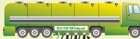
Kabel zu den Überfüllsicherungen
