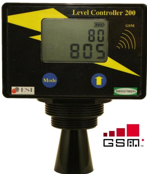
LC 200 wertet die Laufzeit von Ultraschallimpulsen aus um den Flüssigkeitspegel im Tank zu erfassen. Damit sind Fehlfunktionen wie bei mechanischen Geräten ausgeschlossen. Alle gängigen Tankbauformen wie kubisch, zylindrisch, liegend oder stehend können angezeigt werden. Aus diesen Informationen wird der Tankinhalt in Litern errechnet, Tagesverbrauch und Vorrat in Tage des Tankinhalts werden ebenfalls angezeigt.
