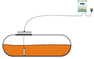
SECU Tank 1 erfüllt die Anforderungen der DWA-A 791-1 mit eindeutiger Anzeige des Füllstandes als Volumen mit hoher Genauigkeit.
